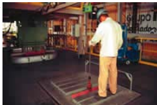
圖 4 : Caraiba Metais : 預熱爐 : 銅板預熱 (前半部) 位於結合熔解/保溫爐---單一感應爐
