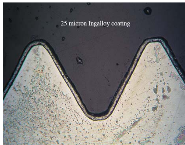
圖二、CFG 製程控制模厚在 25 \mu\text{m} 顯影圖
