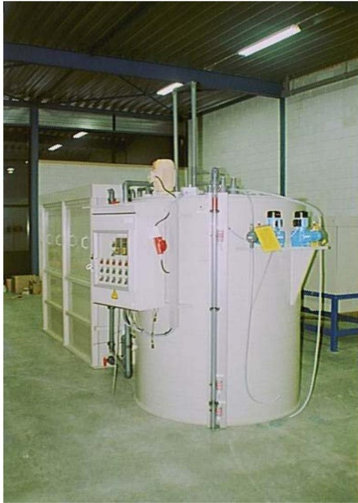
圖三、助鍍液 FLUX 清潔過濾系統
